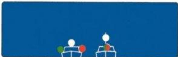
Nave a motore di lunghezza inferiore a metri 50 (a sinistra), e metri 12 (a destra), viste di poppa.
